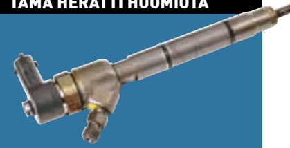
Yhteispaineruiskutuksen ruiskutus-suuttimet toimivat moitteetta ja ovat myös ulkoisesti virheettömiä.
