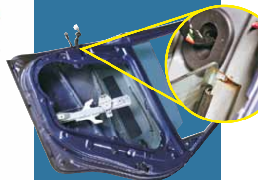
Oven verhoiluun takaa löytyi ruostetta saranoiden reunoista ja ikkunan ohjaimista.
