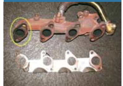
Pakosarjan ja sylinterinkannen välinen tiiviste ei olisi kestänyt enää pitkään.
